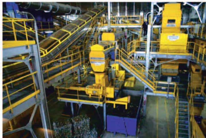
▲ Impianto TMB, sezione di recupero materiali - Roma -
